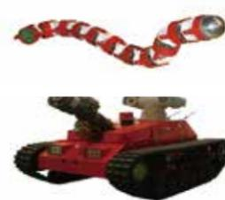
机电硐室机电设备在长期运行过程中易发生故障，借助5G技术，硐室机器人可7×24小时连续工作，代替人工周期性巡检，实现全时全程监控。机器人上还安装有红外摄像头和声音拾取装置，能够探测井下电缆、管道温度，识别电力系统负荷过载的隐患，提前对故障进行预警。
