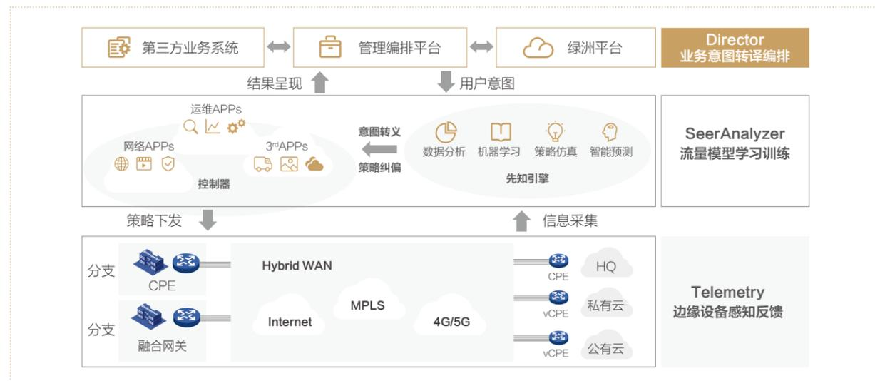
◉ **设备层：**网络设备通过SNMP、NETCONF、BGP-LS、Openflow等通用南向协议接收SDN Controller控制和管理，同时在转发层进行优化，支持Segment Routing、Openflow、IPSec等数据转发。
