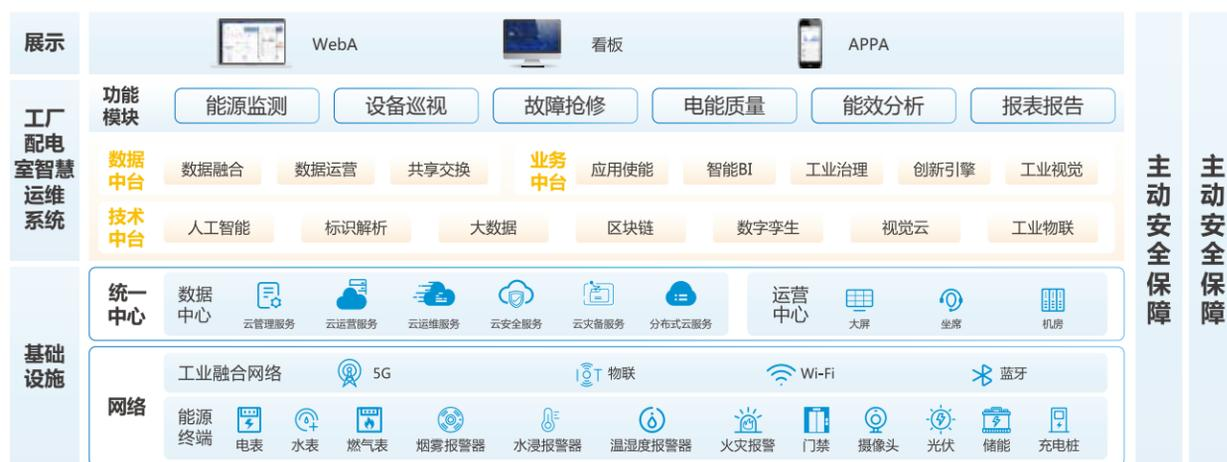
图2 工厂配电室智慧运维系统功能架构
