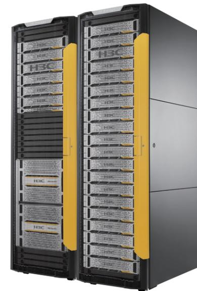
H3C UniStor CF22000系列存储是企业级闪存与现代化企业级存储的完美结合，共有22045/22080 R2/22084 R2/22085 R2四款型号，最多32个控制器节点，全面支持传统硬盘（HDD）与闪存固态硬盘（SSD）的混合配置，拥有多达640个16 Gbps FC端口，最高超过1500万IOPS的性能，以及最高100PB可用容量的可扩展性。
