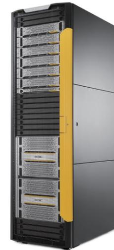
H3C CF8800/9900系列全闪及融合闪存存储可以统一提供块存储、文件存储和对象存储，最高可扩展至16/24个控制器，闪存优化架构提供了出色的传统硬盘(HDD)与闪存固态硬盘(SSD)混合阵列和全闪存阵列的能力，拥有超过数百IOPS且小于0.5毫秒延时的性能，以及最高35PB的原始容量的可扩展性。
